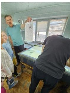
После ультрафиолета распечатка с пленкой на пластине направляется в смывочную машину, там смываются все ненужные элементы материала, оставляя и укрепляя нужные компоненты.
